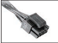
4+4-Pin ATX/EPS CPU-Stecker
