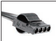
4-Pin-Anschluss für Laufwerke, Peripherie und sonstige Komponenten
