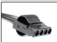
4Pin 周邊硬碟 /光碟機接頭
