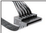
Serial ATA 硬碟/光碟機接頭
