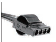
4-Pin-Anschluss für Laufwerke, Peripherie und sonstige Komponenten
